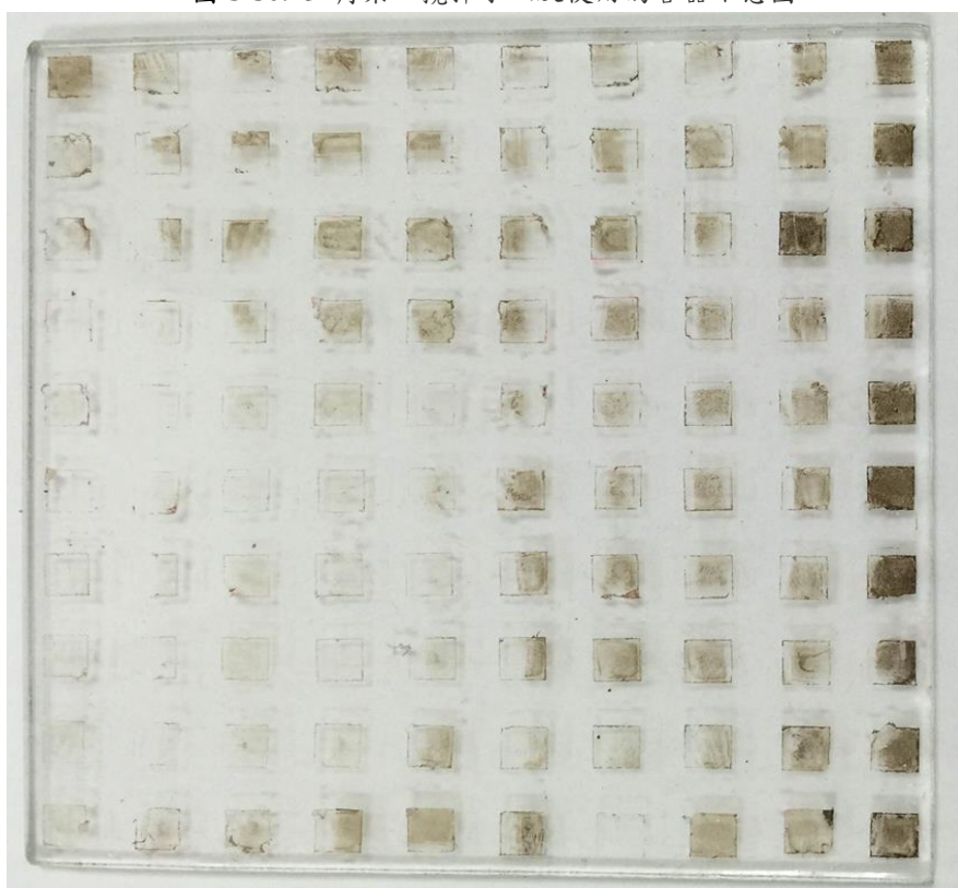
圖 3-51. 將 10 cm x 10 cm FTO 導電玻璃放在三角架上，於 80°C 醋酸鈷與過錳酸鉀的混和溶液中，反應持續 15 分鐘後取出
