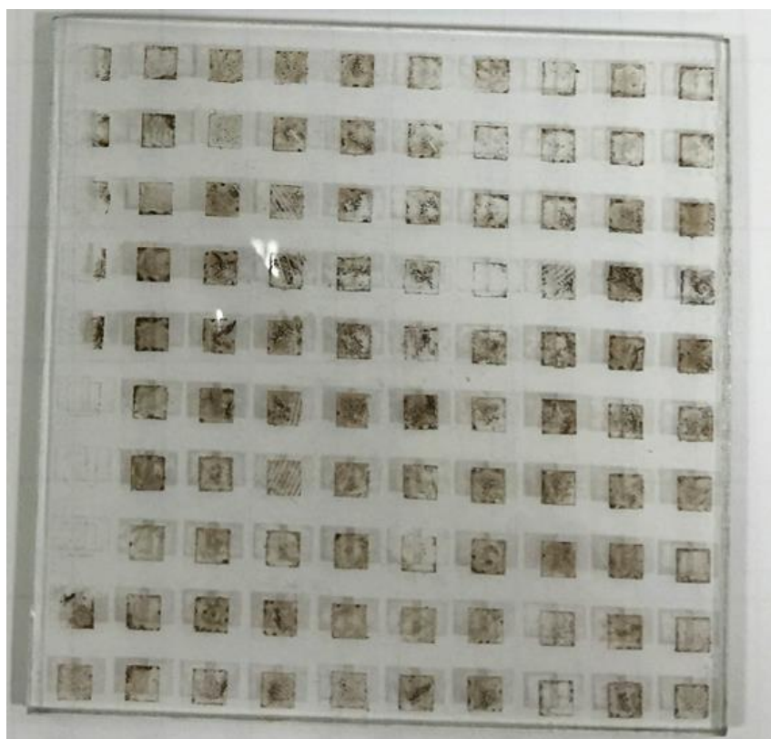
圖 3-49. 將 10 cm x 10 cm FTO 導電玻璃置入 80°C 醋酸鈷與過錳酸鉀的混和溶液中，反應持續 15 分鐘後取出
