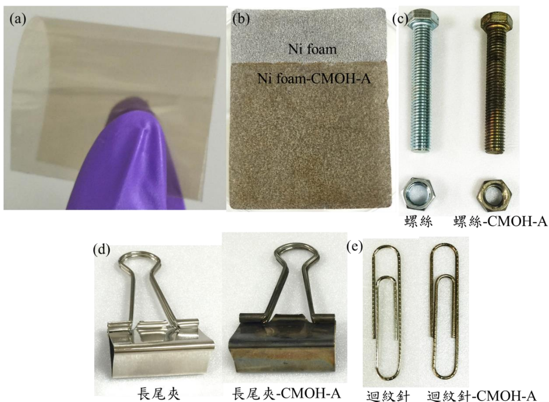
圖 4-5. 以醋酸鈷前驅物於不同物體上鍍膜 (a) PET 軟性基板(b) Ni foam (c) 螺絲 (d) 長尾夾 (e) 迴紋針。備註：(c)(d)(e) 為長時間(約 30 min)放入溶液中後得到的結果
