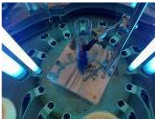
圖 2-5 光反應器內石英管平行於紫外光源
