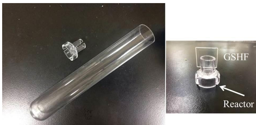
圖 2-4 石英管與特製石英反應器
