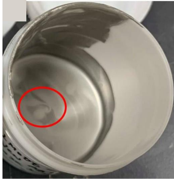
圖 4-1. 石墨烯包裹銀片製成之銀膠不均勻圖 46 。
