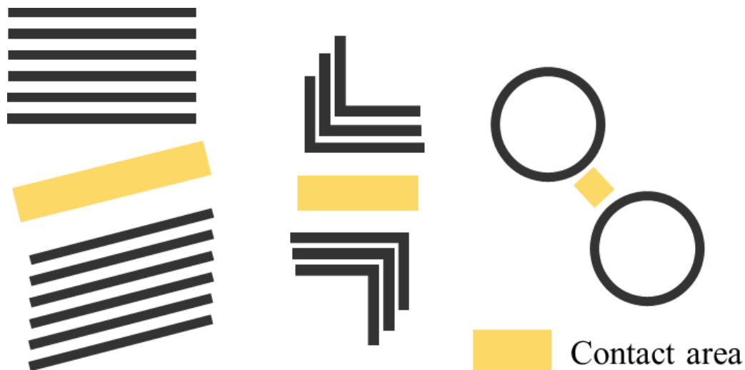
圖 4-2. 石墨烯凡德瓦作用力面積示意圖。
