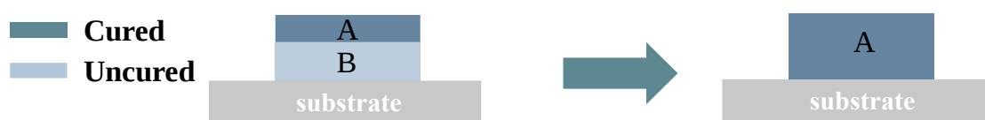
圖 3-15、透過增加上層固化層來解決底切之示意圖
