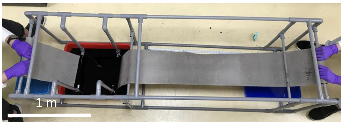
圖 3-1 利用此捲送製程裝置進行大規模 CMOH 製作
