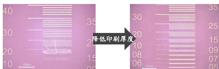
圖 5-1 印刷厚度(左) 15.3 \pm 2.1 \mu\text{m} (右) 8.6 \pm 0.4 \mu\text{m}
