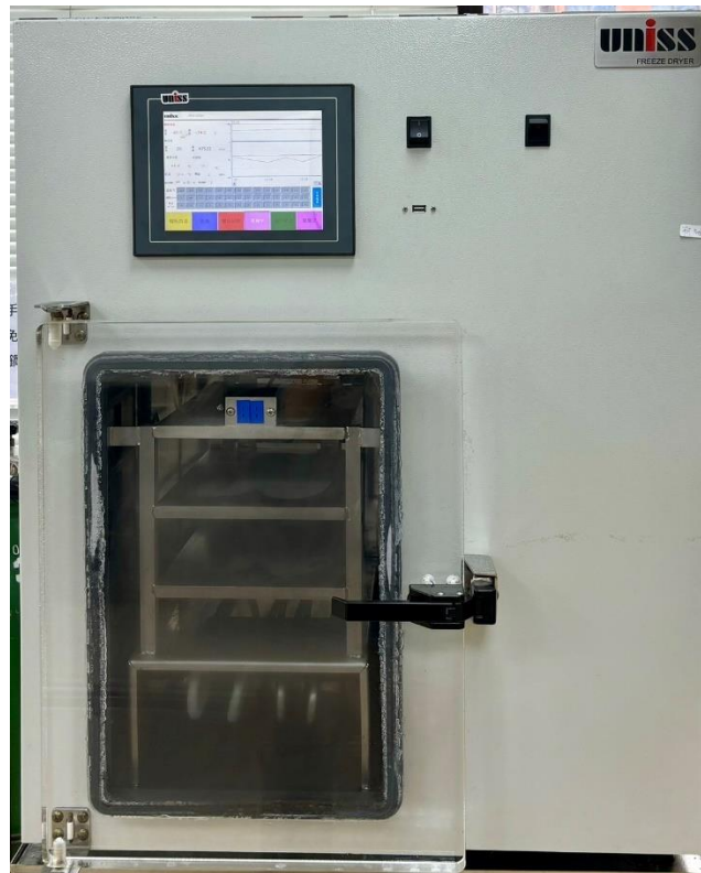
圖 1-11. 市售的兩公斤級棚版式冷凍乾燥機台照片 53 。
