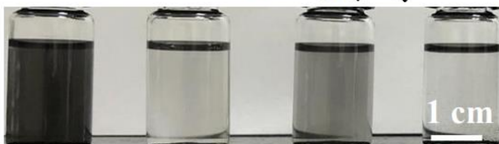
圖 1-9. 球狀石墨烯與其他碳材料的分散性測試，溶劑：酒精 8 。
